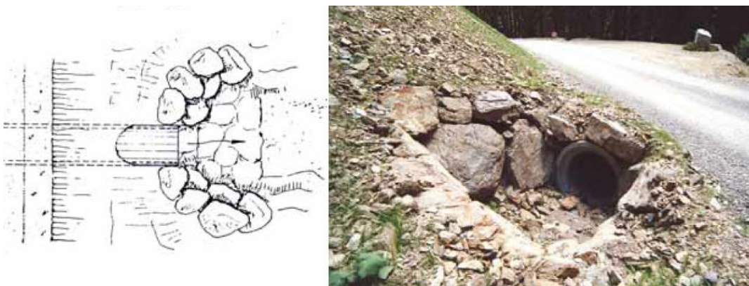
Figura 7-3: Pozzetti in legname e in massi (fonte: “Viabilità forestale regionale” Bortoli, P.L. 2001).
